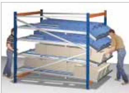
Separerade områden för inlastning och plockning ger orderplockning utan störningar och problem.
